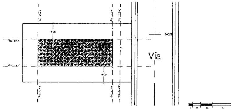
1.2.3 Adosamiento: Se edificará unicamente hasta una altura vertical máxima de 5m sobre el nnt, definida por el límite determinado entre el nnt y una paralela del mismo; dentro del lindero del lote, con la protección necesaria y suficiente hacia el vecino, y en caso de existir construcción, se deberá respetar el perfil de la culata previamente construida.
