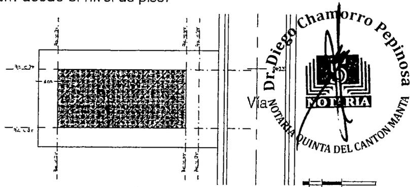
1.3.2 Retiro Posterior de 4m: Es el límite establecido desde los 4m del lindero posterior, hacia el interior del lote. Se permitirá la edificación de fachadas con vanos para puertas y ventanas. Los lotes que limiten con zonas verdes tendran cerramientos con muro de piedra de max 60cm de altura y setos con malla.
