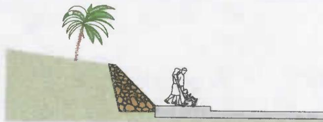
1. En el caso del cerramiento posterior y cerramientos laterales será un muro jardinera de 1,00m de altura, el cual estará recubierto de roca de cualquiera de las referencias mostradas para el cerramiento frontal, adicionalmente en este muro jardinera se sembrará la sansevieria (lengua de suegra) como se muestra en los gráficos, además no se permiten rejas, vidrios y ningún tipo de alambrado sobre los muros.
