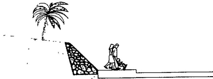
1. En el caso del cerramiento posterior y cerramientos laterales será un muro jardinera de 1,00m de altura, el cual estará recubierto de roca de cualquiera de las referencias mostradas para el cerramiento frontal, adicionalmente en este muro jardinera se sembrará la sansevieria (lengua de suegra) como se muestra en los gráficos, además no se permiten rejas, vidrios y ningún tipo de alambrado sobre los muros.
